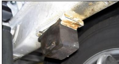
**NL** Verwijder beide aanslagrubbers van het chassis.
