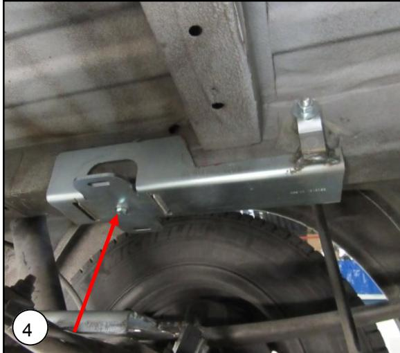
**NL** Monteer de bovenbeugel op de montageplaat en schroef deze vast met de M8 x 20 bout en borring.
