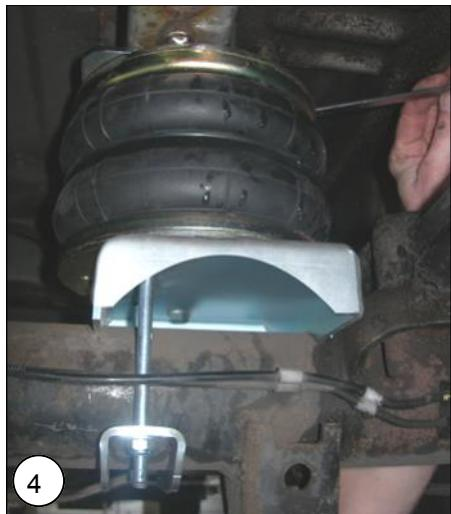
**NL** Lijn de onderplaat uit met de bovenplaat zodat de balg er recht onder geplaatst kan worden.
