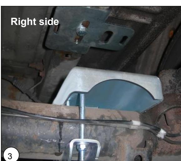
**NL** Plaats de onderplaat op de plek van de aanslag van het aanslagrubber. Zorg dat de onderplaat over de schotel valt.
