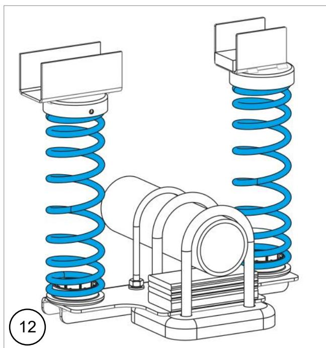
**FR** Placez le support de ressort supérieur autour du châssis, placez le ressort auxiliaire dans le support de ressort supérieur et soulevez/glissez le ressort auxiliaire sur le support de ressort inférieur.
