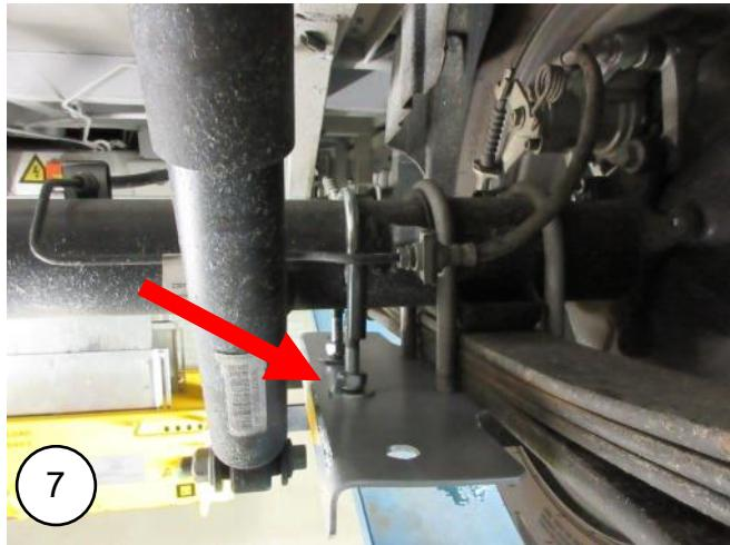
**NL** Draai de moeren, tot de bovenzijde van de U-beugel gelijk ligt met de bovenzijde van de as.
