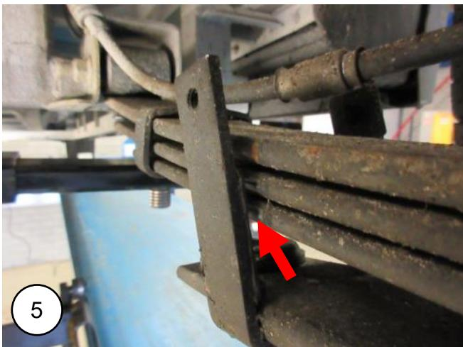
**DE** Montieren Sie die vier Muttern der Blattfederschlingen.
