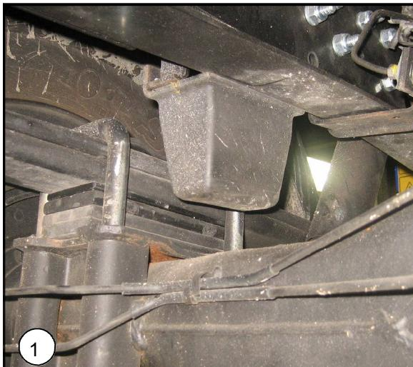
**NL** Verwijder beide aanslagrubbers van het chassis.
