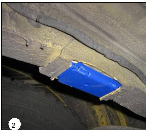
**NL** Plaats de klemplaten in het frame van het stootrubber
