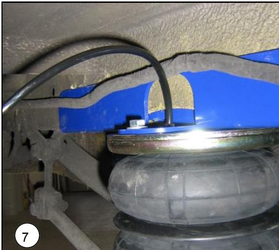
**NL** Let er bij het doorvoeren van de slang op dat deze niet beschadigd wordt of klemt. Zet nu de balg vast aan de boven en onderplaat.
