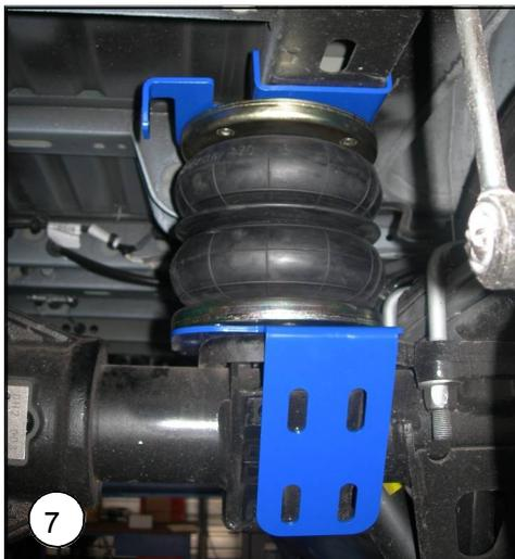
**NL** Plaats de luchtbalg met onderplaat op de as, zo als hiernaast wordt weergegeven, zorg ervoor dat de luchtleiding niet knikt of beschadigd wordt!
