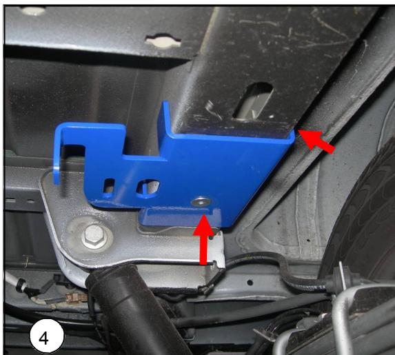
**NL** Zorg ervoor dat de bovenplaat stevig tegen het chassis is geplaatst
