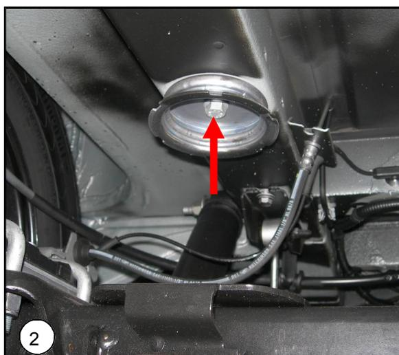
**NL** Verwijder beide schotels van het stootrubber
