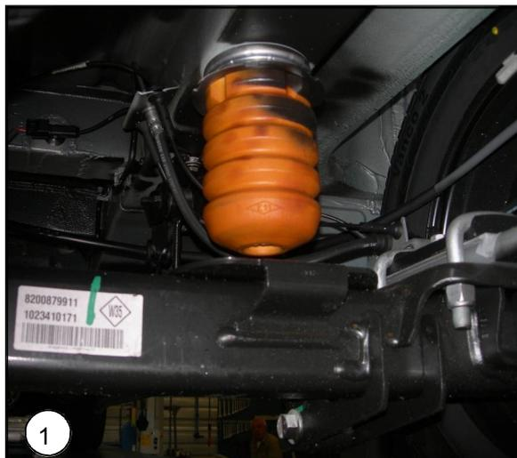
**NL** Verwijder beide aanslagrubbers van het chassis.
