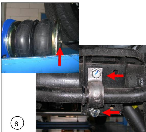
**NL** Bevestig de luchtslang aan de balg, zorg ervoor dat de onderplaat al stevig op de balg bevestigd is. Demonteer de stabilisatiestang voor het plaatsen
