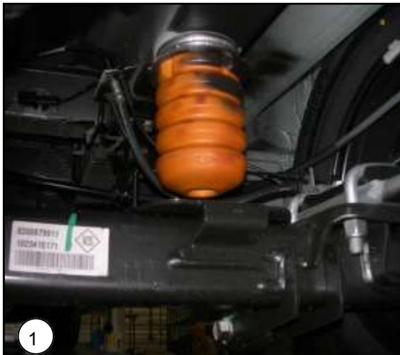
**NL** Verwijder beide aanslagrubbers van het chassis.
