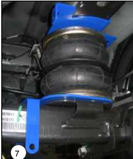
**NL** Plaats de luchtbalg met onderplaat op de as, zo als hiernaast wordt weergegeven, zorg ervoor dat de luchtleiding niet knikt of beschadigd wordt!
