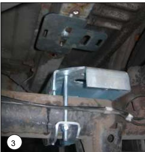
**NL** Plaats de onderplaat op de plek van de aanslag van het aanslagrubber.
