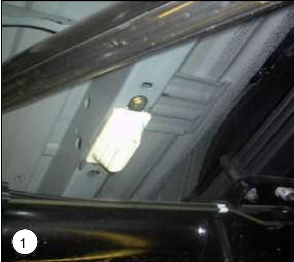
**NL** Verwijder beide aanslagrubbers van het chassis.
