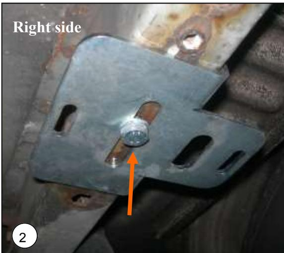
**NL** Plaats nu de bovenplaat op de plek van het aanslagrubber wat verwijderd is.
