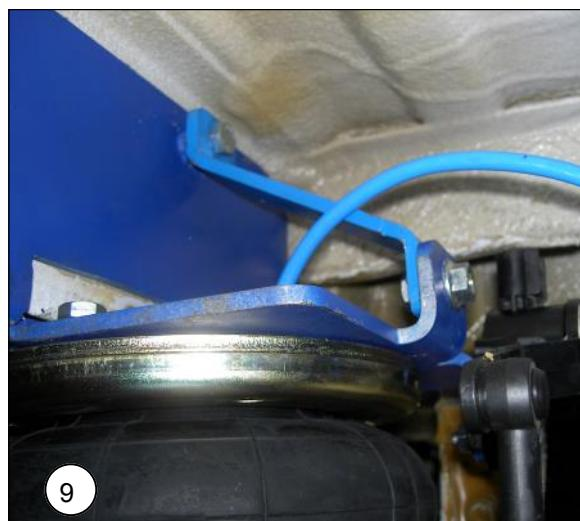
**NL** Plaats de luchtbalg tussen de platen en voer de luchtslang door het grote gat in de bovenplaat. Monteer de M8x16 bouten met borg-sluitringen.
