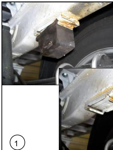
**NL** Verwijder beide aanslagrubbers van het chassis.
