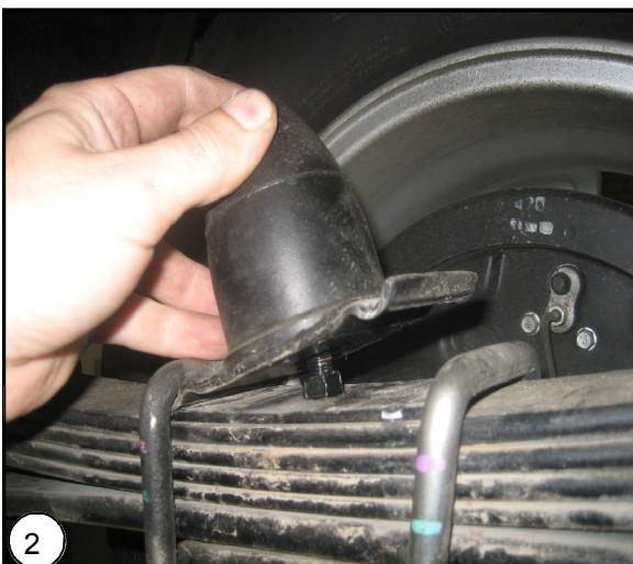
**NL** Verwijder de originele buffer . Deze wordt niet meer gebruikt.
