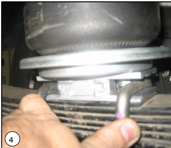
**NL** Monteer de onderbeugel en de U-beugels om de bladveer. Zet de moeren van de U-beugels vast met **120 Nm**.
