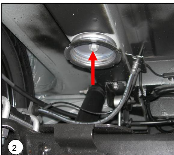
**NL** Verwijder beide schotels van het stootrubber
