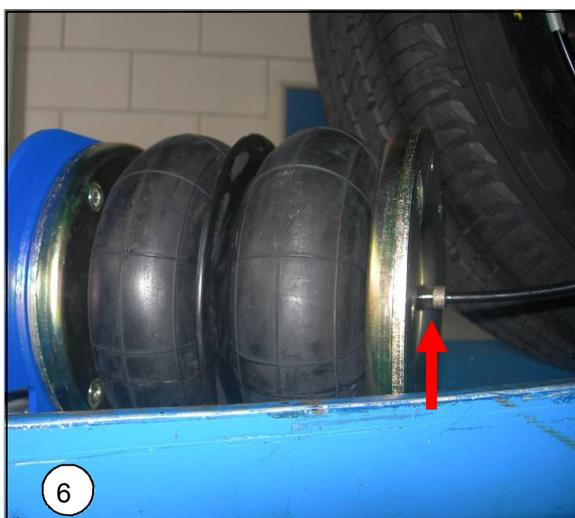
**NL** Bevestig de luchtslang aan de balg, zorg ervoor dat de onderplaat al stevig op de balg bevestigd is.
