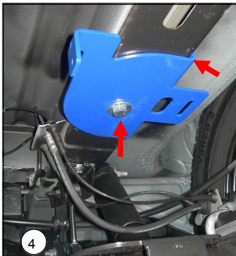
**NL** Zorg ervoor dat de bovenplaat stevig tegen het chassis is geplaatst
