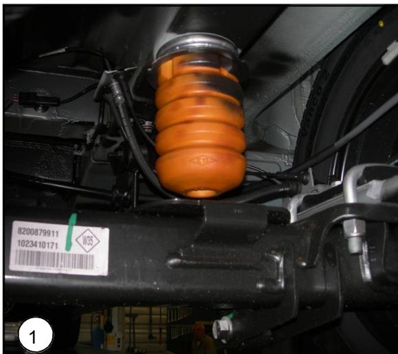
**NL** Verwijder beide aanslagrubbers van het chassis.
