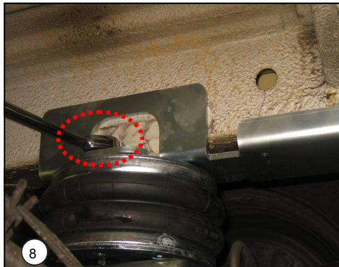
**NL** Let er bij het doorvoeren van de slang op dat de ze niet beschadigd wordt of klemt. Zet nu de balg vast aan de boven- en onderplaat.
