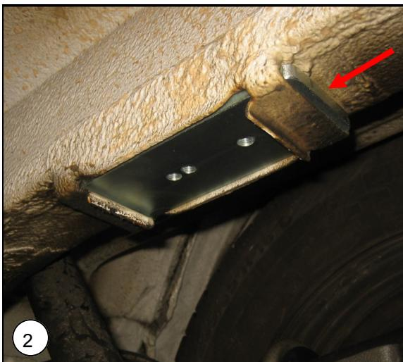
**NL** Plaats de klemplaat in het frame van het stootrubber
