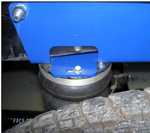
**NL** Monteer de luchtleiding op beide balgen en plaats deze tussen de platen. Zet nu de Balg met lucht slang vast
