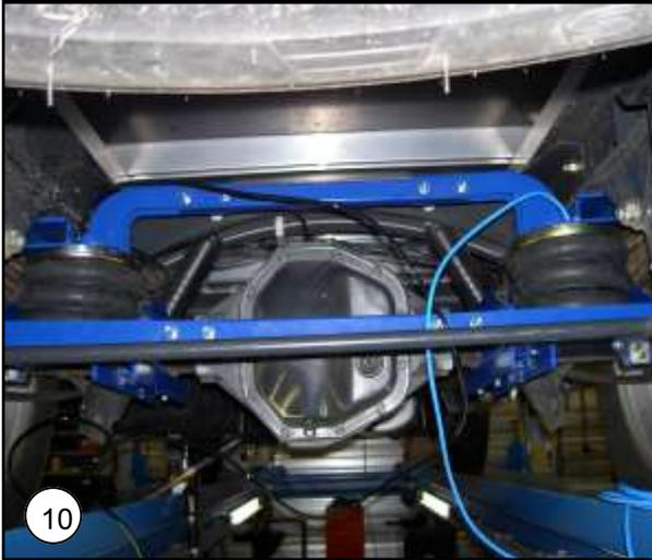
**NL** Let er bij het doorvoeren van de slang op dat deze niet beschadigd wordt of klemt. Zet nu de balg vast aan de boven en onderplaat.
