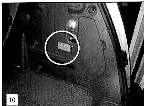
**NL** Plaats achter het paneel de minimumdruksensor en het overdrukventiel. Boor een gat van ø 8 mm en plaats hier het vulventiel. Plak de bijgeleverde druk sticker naast het vulventiel.
