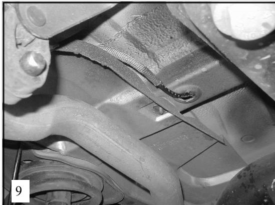
**NL** Voer de luchtleiding van de rechter naar de linker luchtbalg. Gebruik boven de uitlaat de hittebescherming. Verbind de luchtleidingen met het T-stuk. Plaats het overgebleven stuk leiding in het T-stuk.
