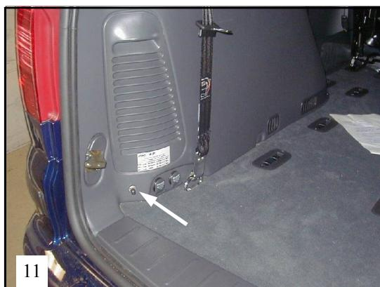
**NL** Monteer achter het paneel de minimum druk sensor en het over rukventiel volgens bijgeleverde handleiding. Boor een gat van **ø 8mm** en plaats het vulventiel op de aangegeven plaats en plak de druksticker boven het vulventiel.
