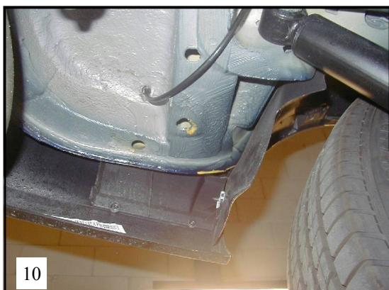
**NL** Boor een gat van **ø 9mm** en voer de luchtleiding naar binnen zodat deze uitkomt achter het paneel aan de linker achterzijde. Gebruik hiervoor het doorvoerrubber.
