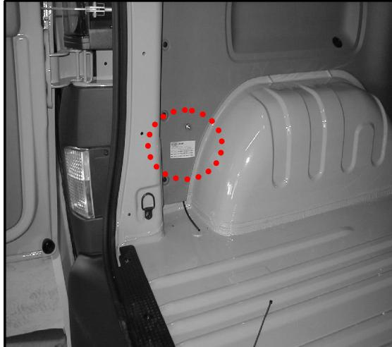
**NL** Plaats het overgebleven stuk leiding in het T-stuk en voer dit naar de binnenzijde van de auto. Plaats de minimum druk sensor en het overdruk ventiel volgens de handleidingen achter het paneel links achter in de auto. Boor een gat van ø 8 mm in het paneel en montereer hier het vulventiel.
