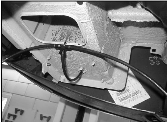
**NL** Voer de luchtleiding van de rechter naar de linker luchtbalg en verbind de balgen met elkaar met het T-stuk. Let er op dat de luchtleiding ten minste 15 cm bij de uitlaat vandaan blijft in verband met smeltgevaar.
