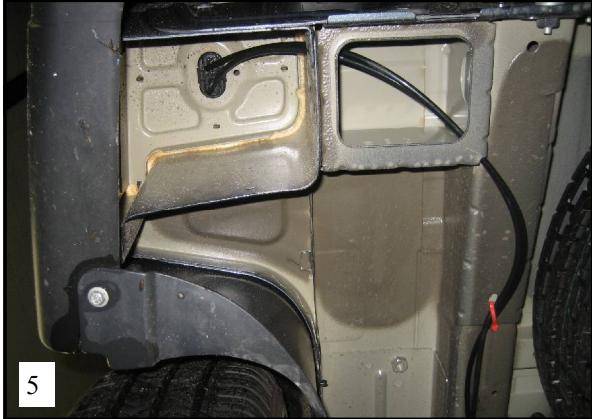
**NL** Voer nu de rechterleiding naar links en verbind daar d.m.v. het T-stuk de linker en rechterleiding. Leid nu de leiding vanaf het T-stuk door een gat in de carrosserie, naar de binnenzijde van de auto.
