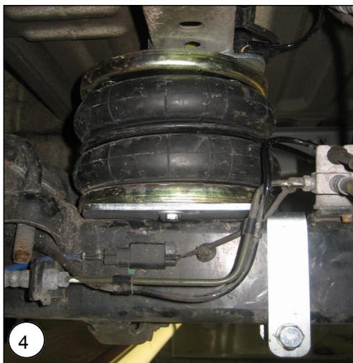
**NL** Lijn de onderplaat uit met de bovenplaat zodat de balg er recht onder geplaatst kan worden. Als dit niet mogelijk is monteer de bovenplaat dan andersom!
