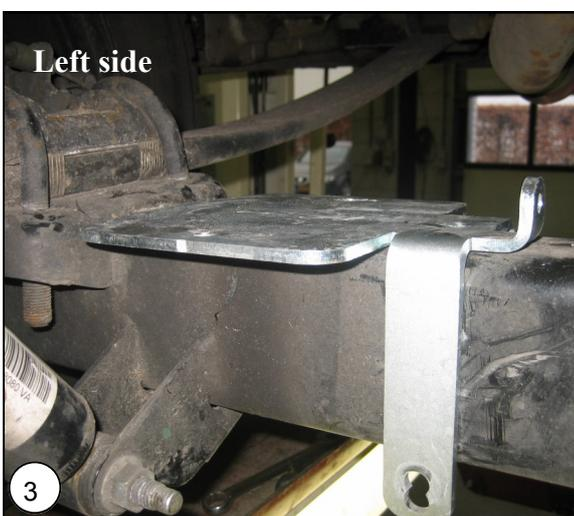
**NL** Plaats de onderplaat op de plek van de aanslag van het aanslagrubber.
