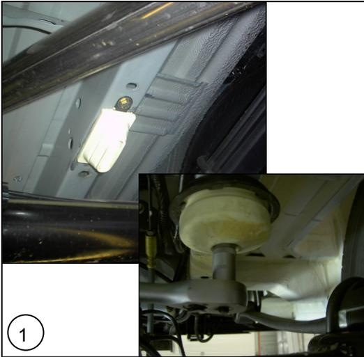
**NL** Verwijder beide aanslagrubbers van het chassis
