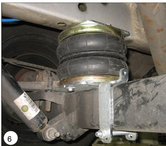
**NL** Monteer de luchtbalg met de luchtaansluiting naar boven.
