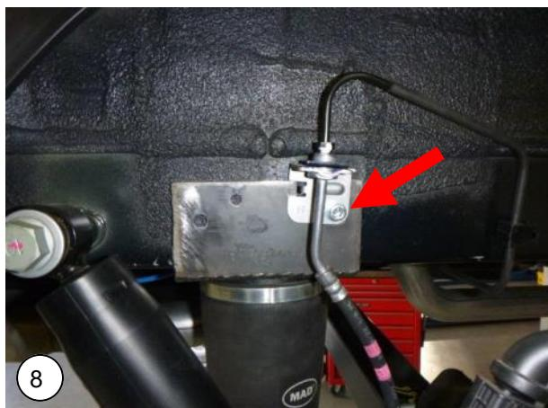
**NL** Sluit de luchtleidingen aan en zet de balgen op druk (1 bar is voldoende). Controleer of de beugel tegen de chassisbalk zit en zet dan de M8x30 bout vast.
