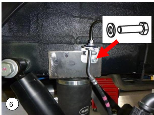
**NL** Druk de luchtbalg in, en schuif de bovenste beugel onder de steun van de remleiding. Monteer de **M8x30** zeskantbout met de **borgring**, maar laat deze nog enkele slagen los.
