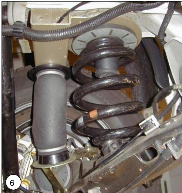
**NL** Plaats de hoofdveer en zet de auto weer op zijn wielen. Let op dat de bovenbeugel goed in het chassis centreert en dat de veer goed in de slotjes van de originele veerschotels valt. Monteer de onderste schokdemper bevestiging (**150 Nm+90°**)
