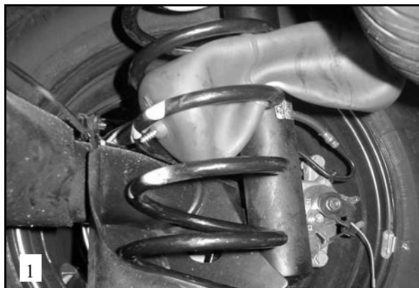
**NL** Laat de auto uit de veren hangen. Druk de lucht uit de balg en schuif de balg tussen de windingen door in de veer. Het ventiel moet naar beneden wijzen.
