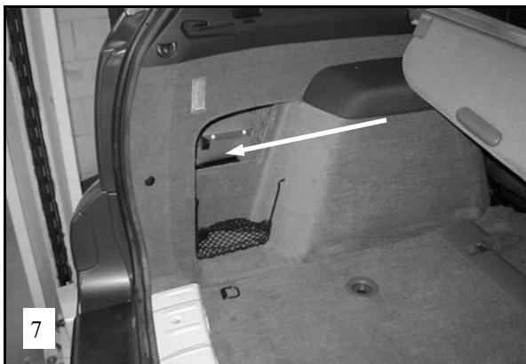
**NL** Monteer het overdrukventiel en de minimumdruksensor volgens de bijgeleverde handleidingen achter de bekleding op de aangegeven plaats.
