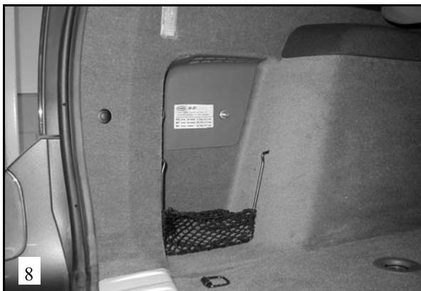
**NL** Boor een gat van **ø8mm** in de kap en monteer hier het vulventiel. Plak de druksticker naast het vulventiel
