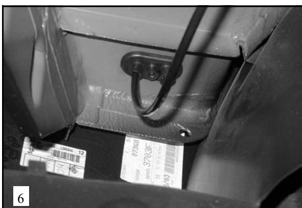
**NL** Voer de luchtleiding door de bestaande doorvoertule aan de linker achterzijde naar de binnenzijde van de auto.
