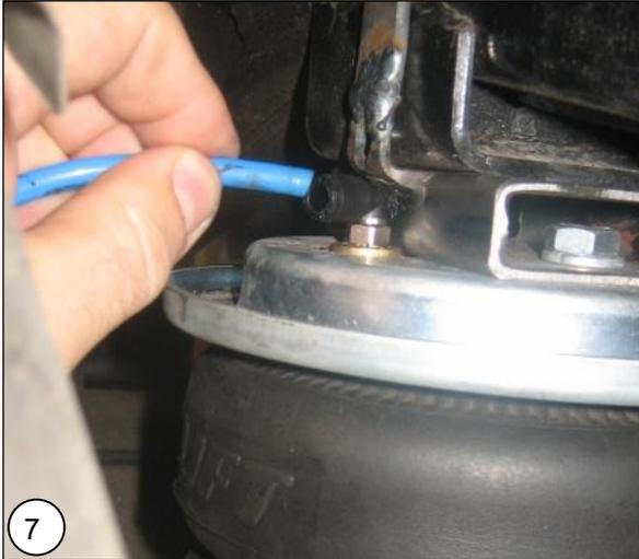
**NL** Plaats de auto op zijn wielen en monteer de luchtleiding in de luchtbalg. De afbeelding kan afwijken i.v.m. de plaats van de luchtaansluiting.
