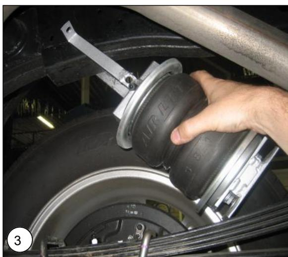
**NL** Plaats de luchtbalg met beugels tussen de as en chassisbalk. Zorg ervoor dat de luchtaansluiting naar binnen gericht staat. Deze aansluiting kan zowel aan de onderzijde als aan de bovenzijde zitten.
