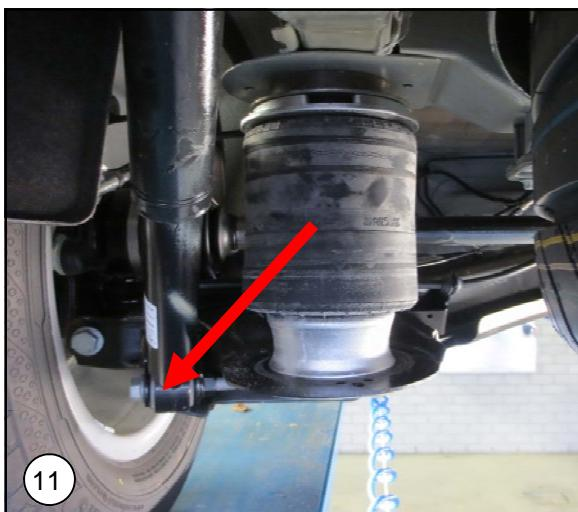
**NL** Zet de schokdempfer vast met de originele bout. Laat de auto nog NIET helemaal zakken. Hierdoor kan onherstelbare schade aan de luchtbalg ontstaan.
