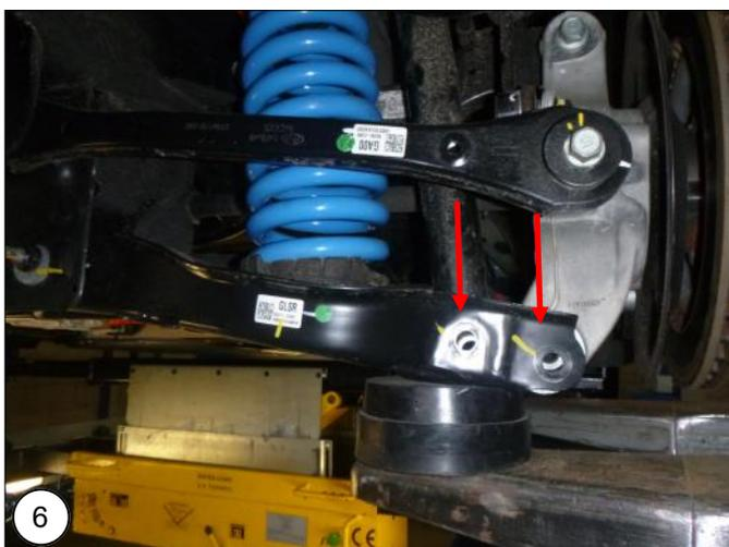
**NL** Ondersteun de draagarm en monteer de schokdemperbout en de draagarmbout. **Let op: Draai deze nog niet vast!**
