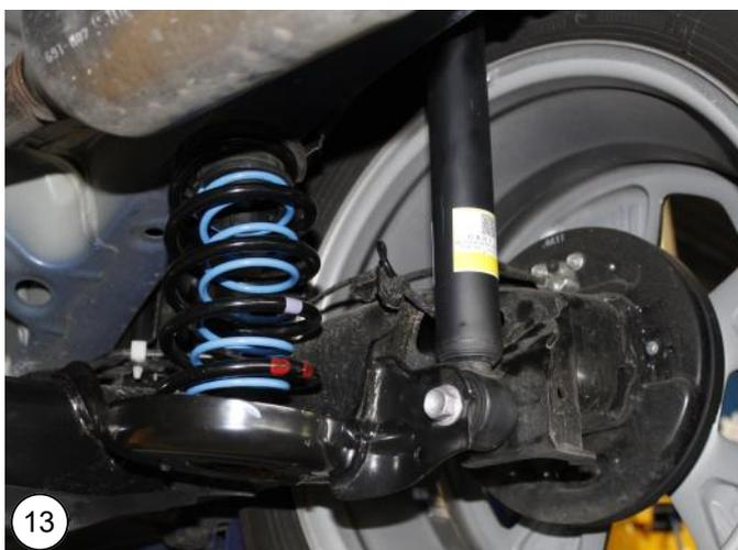
**NL** Laat het voertuig helemaal zakken en zet dan de schokdemperbouten helemaal vast.
