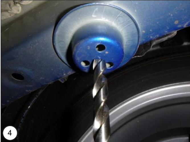
**NL** Boor in het chassis een gat van **Ø11,5mm** tussen de 3 bestaande gaten,
