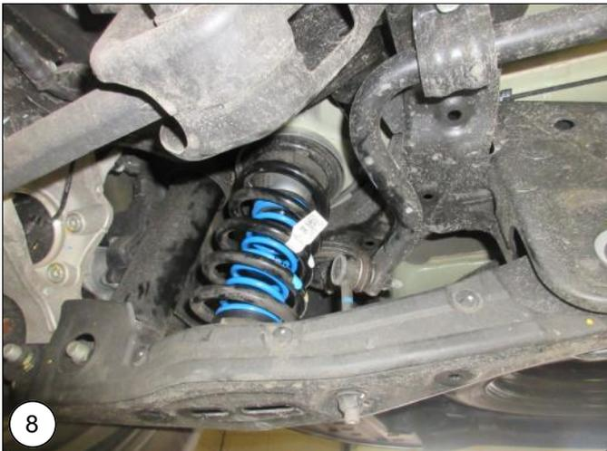
**NL** Monteer de moer van de stabilisatorstang, de schokdemperbout en de draagarmbout. **Let op: draai deze nog niet vast!**
