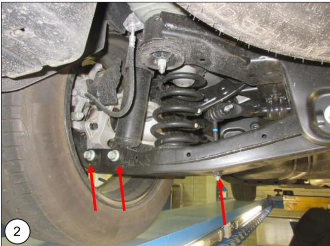
**NL** Ondersteun de draagarm en verwijder de moer van de stabilisatorstang, de schokdemperbout en de draagarmbout aan de wielzijde. **Let op: De draagarm staat onder spanning van de veer!**
