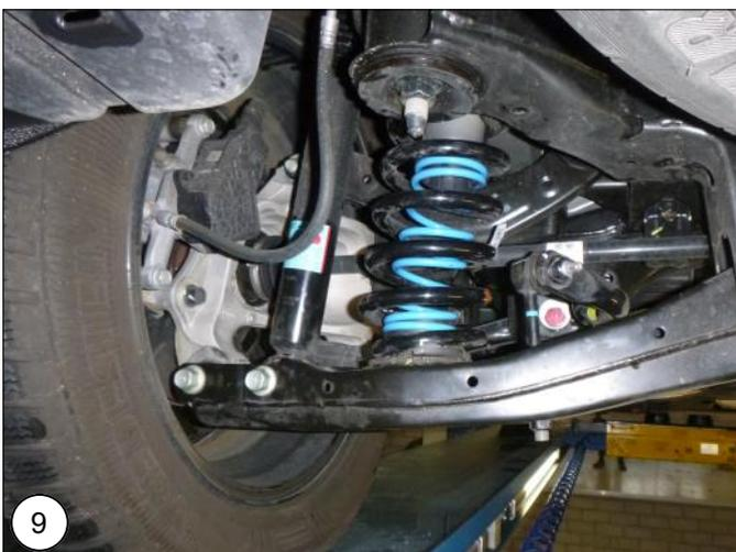
**NL** Monteer de wielen en laat de auto zakken. Controleer of de hulpveren en veerschetels goed gecentreerd zitten. Draai vervolgens alle bouten en moeren vast met het voorgeschreven aanhaalmoment.
