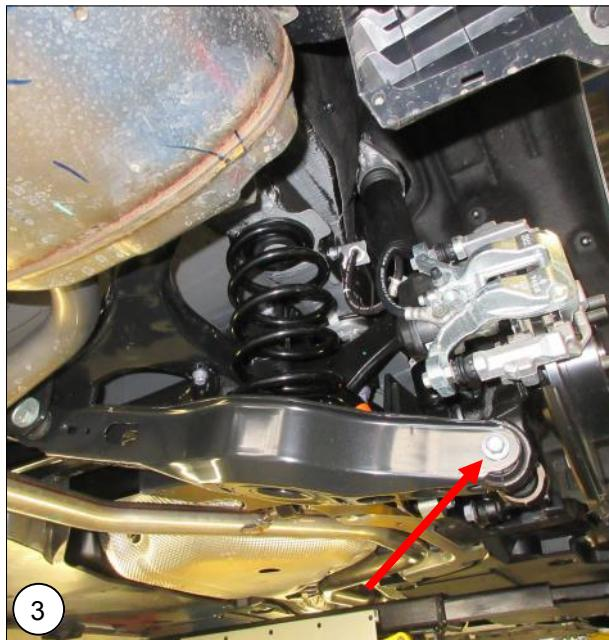
**NL** Ondersteun de draagarm en verwijder de bout uit de draagarm aan de wielzijde. **Let op de hoogte sensor.**
