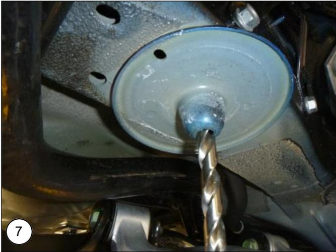
**NL** Boor het gat in de carrosserie op naar Ø11 mm. Behandel het gat met een corrosie werend middel.
