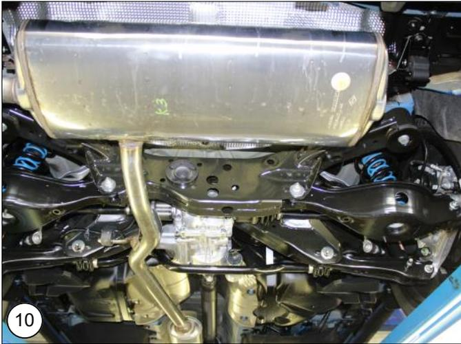
**NL** Laat het voertuig zakken op de wielen en draai de draagarm bout en wielbouten vast naar het voorgeschreven aanhaalmoment.
