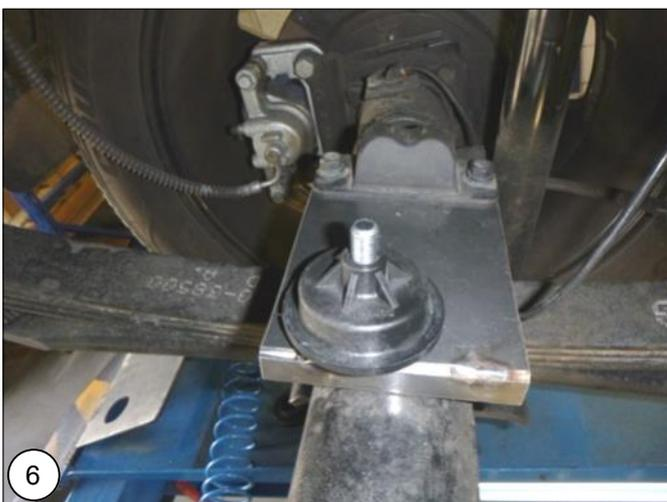
**NL** Monteer de buffer op de onderbeugel met de bijgeleverde M10 bouten en borgschotelveren. Zet de bouten nog niet vast.
