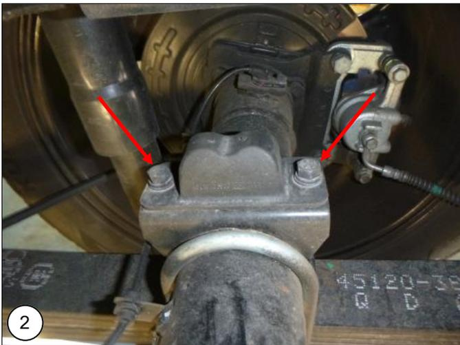
**NL** Demonteer de buffer. Het originele montagemateriaal wordt niet meer gebruikt.
