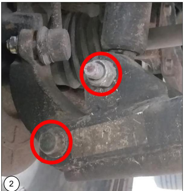
**NL** Ondersteun de draagarm en verwijder de bouten van de schokdemper en de draagarm (wielzijde). **Let op:** de draagarm staat onder veerspanning!
