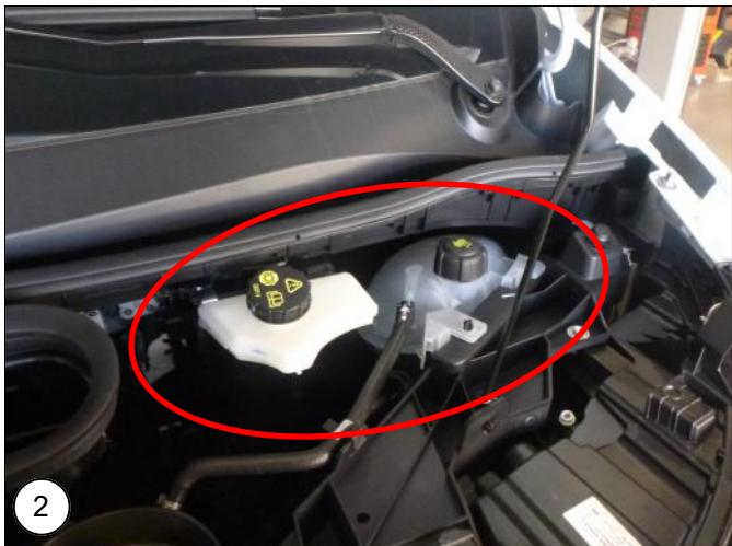
**NL** Verwijder het koel- en remvloeistof reservoir om de montage makkelijker te maken.
