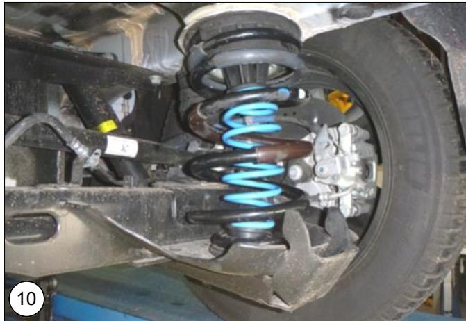
**NL** Laat het voertuig helemaal zakken en zet de demperbouten vast. Monteer ook de steunen van de remslangen en de hoogtesensor indien aanwezig.
