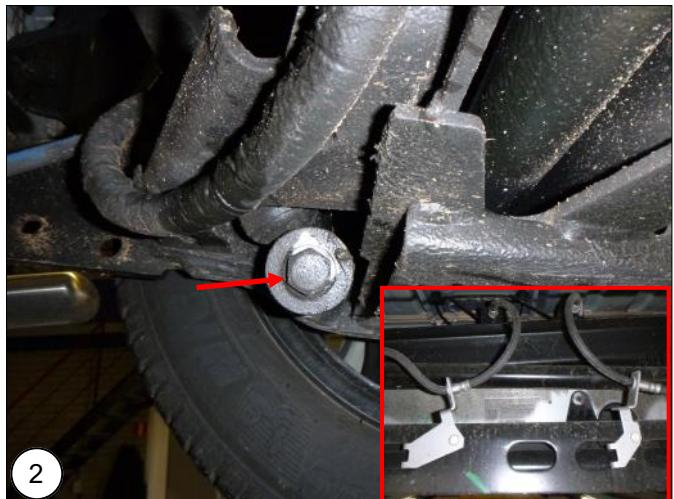
**NL** Demonteer de onderste schokdemperbouten, steunen van de remslangen en hoogtesensor indien aanwezig.
