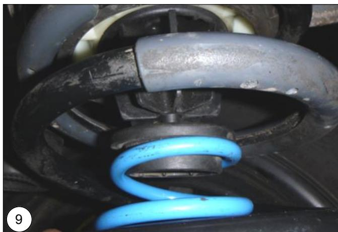
**NL** Laat het voertuig iets zakken en controleer of de hulpveren en veerschotels goed gecentreerd zitten. Montere daarna de onderste demperbouten, maar zet deze nog niet vast.
