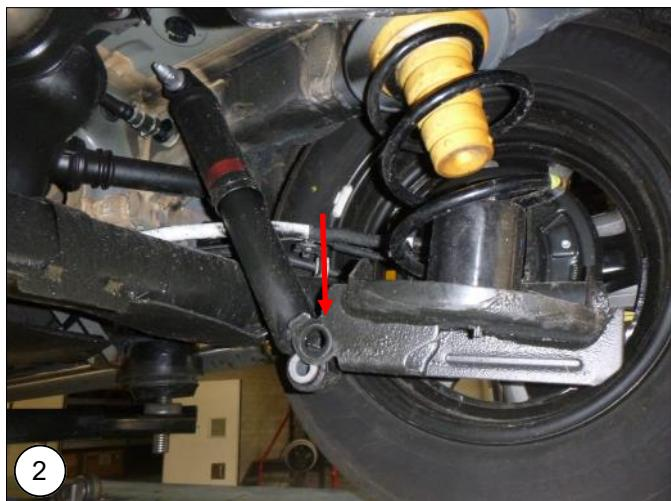
**NL** Verwijder de schokdemper bouten aan beide kanten en hef het voertuig. Let op de remslangen en kabels!
