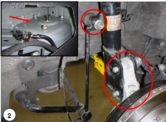
**NL** Verwijder de veerpoot door het loshalen van de weergegeven bouten boven en onder.
