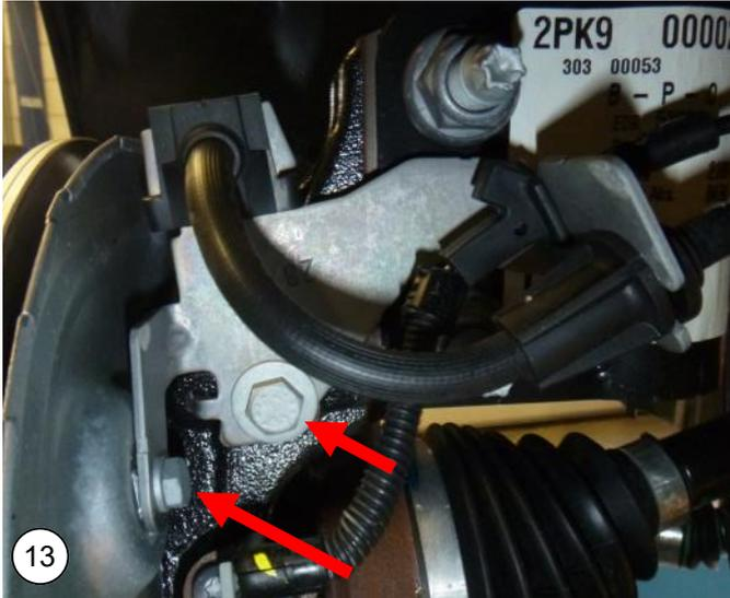
**NL** Demonteer de steun van de ABS kabel en rem-slang.
