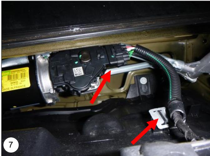
**NL** Verwijder het bovenste deel van de paravan, en koppel de stekker van de ruitenwissermotor los. Maak ook de bevestigingspunten van de kabel los. (Zie afbeelding 7 & 8)
