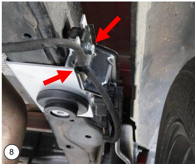
**NL Rechterzijde:** Indien aanwezig, monteer de sensorebeugel met de meegeleverde bout **3**. Zet de bedrading vast met een kabelbandje.
