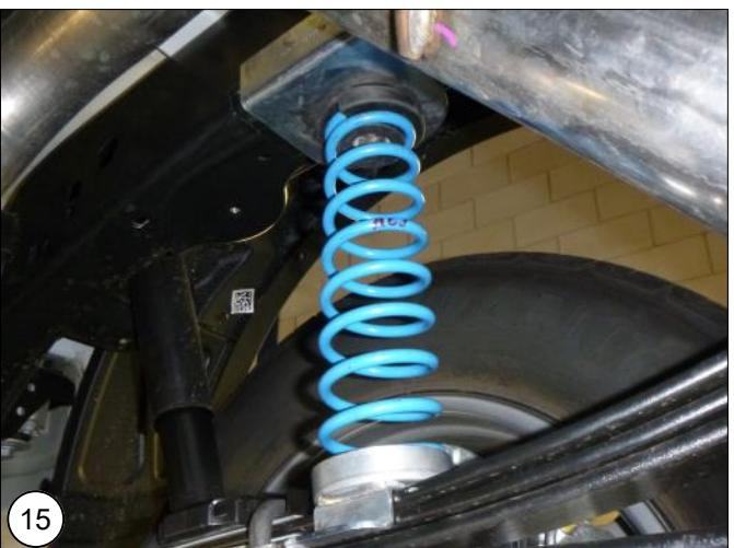
**NL** Zorg ervoor dat het windingseinde naar binnen wijst. Controleer of dat de windingsuiteinden goed tegen de sloten van de rubbers zitten.
