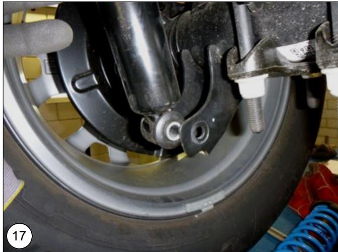
**NL** Plaats de bout terug in de schokbreker. **Draai deze nog niet vast.**
