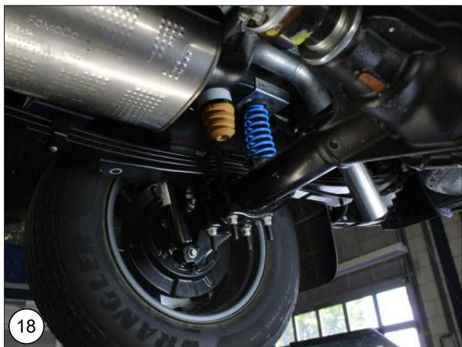
**NL** Laat het voertuig in de veren zakken, Draai daarna pas de schokbrekerbout vast.
