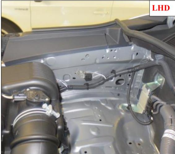
**NL** Alleen **Left Hand Drive**: Bevestigingspunten compressorunit. Rechts in het motorruim. Plaats in het gat zonder schroefdraad de meegeleverde blindklinkmoer met een blindklinkmoerentang.
