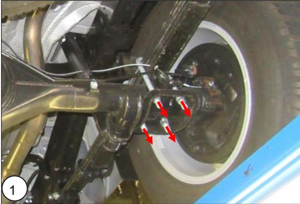
**NL** Draai de vier moeren van de veerstroppen een stukje los. Doe dit niet aan beide kanten tegelijk.
