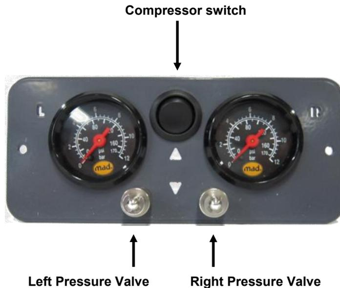
**NL** Door middel van de 'Compressor Switch' kunnen de balgen worden opgeblazen. De manometers zullen de luchtdruk van beide balgen weergeven. Als er een balg teveel druk heeft kan deze afzonderlijk aangepast worden door het ventiel 'Pressure Valve' in te drukken.
