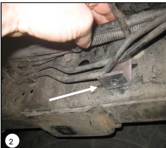
**NL** Plaats de klembeugels van de bovenplaat over de chassisbalk van het voertuig.
