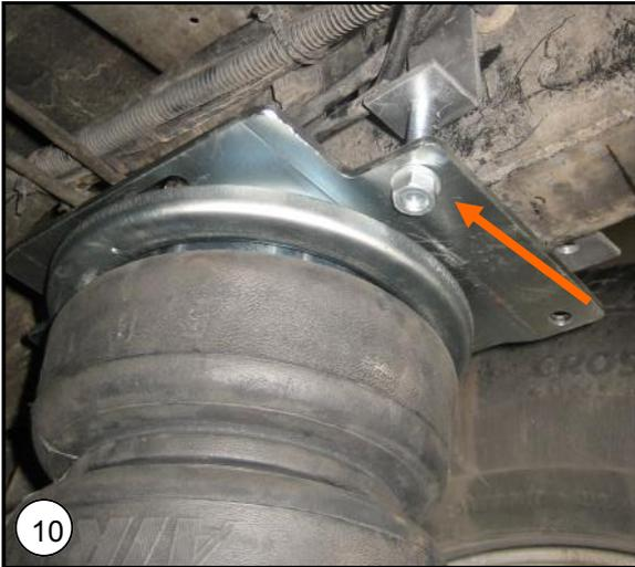
**NL** Zet de bovenbeugel met de M8x30, M8 sluitring en de M8 borgmoer vast aan de U-beugel.
