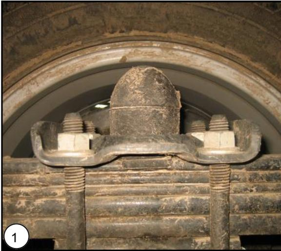
**NL** Hef de auto uit zijn veren. Zorg ervoor dat de wielen NIET vrij hangen. Verwijder de buffer door de veerstroppen los te draaien.
