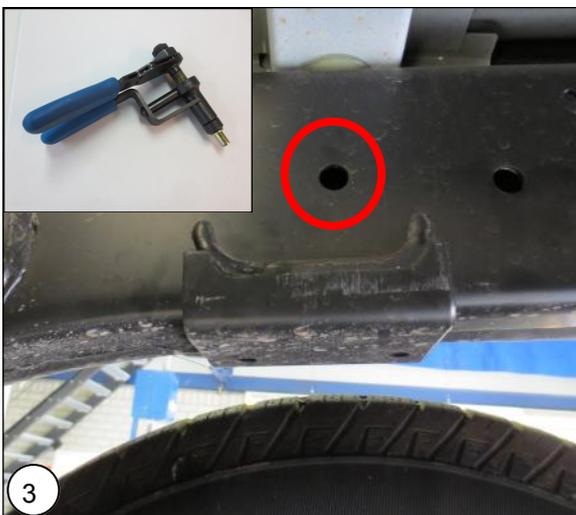
**NL** Rechts: Boor bestaande gat op naar  $\varnothing$  12-mm. Plaats de meegeleverde M10 blindklinkmoer in het zojuist geboorde gat. Gebruik een blindklinkmoerentang om de meegeleverde draadbus te fixeren.
