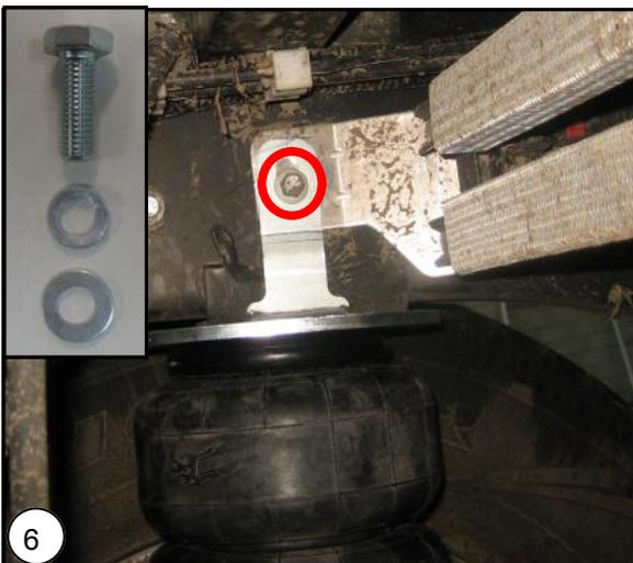
**NL** Laat de auto zakken. Plaats bij voertuigen zonder brandstofkoeler de M10 carrosserie ring om de ruimte uit te vullen. Zet de bovenzijde vast met bijgeleverd montage materiaal.
