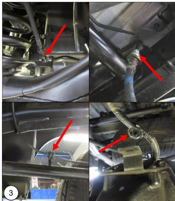
**NL** Maak de volgende onderdelen los van de steunten: remslangen, kabels op de stangen van de ophanging en de kabel op het differentieel.
