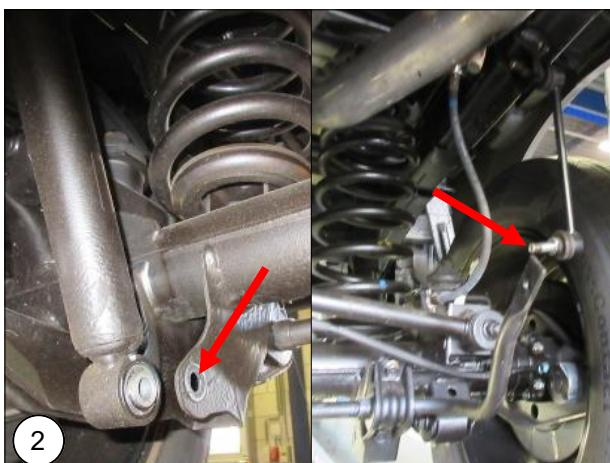
**NL** Demonteer de onderste schokdempertuten, reactiestangen van de stabilisatorstang en indien aanwezig de hoogte sensor.
