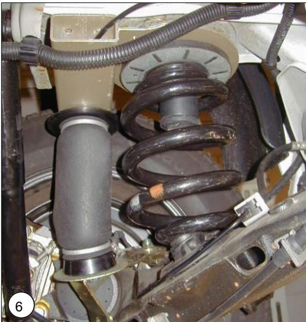
**NL** Plaats de hoofdvuur en zet de auto weer op zijn wielen. Let op dat de bovenbeugel goed in het chassis centreert en dat de veer goed in de slotjes van de originele veerschotels valt. Monteer de onderste schokdemper bevestiging (**150 Nm+90°**)
