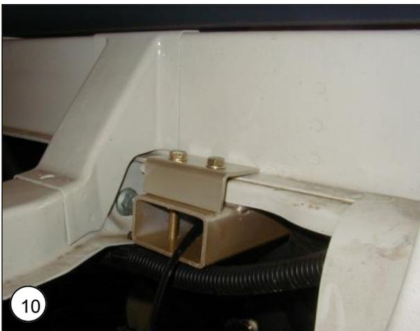
**NL** Plaats het ongelijkzijdige hoek profiel op de bovenbeugel over de velsrand van het chassis. Monteer de twee M8 bouten en zet deze vast met **15 Nm**.
