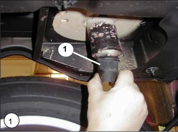
**NL** Demonteer de onderste schokdemperbevestiging. Maak het steuntje van de ABS kabel aan de draagarm los. Hef de auto uit de veren en verwijder de hoofdveer met veerschotel. Demonteer de originele buffer. (deze wordt niet meer gebruikt).
