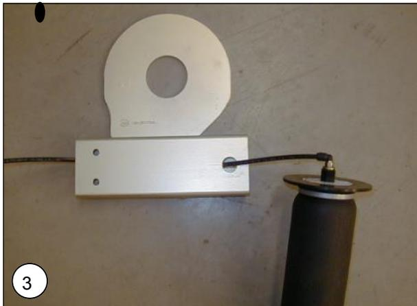
**NL** Voer de luchtleiding door de kunststof moer en door de bovenbeugel. Druk de luchtleiding in de aansluiting van de luchtbalg. Let op dat de bovenbeugel met de letter **L** op het eind op de balg komt waar de letter **L** op de onderbeugels staat. (Linker kant)
