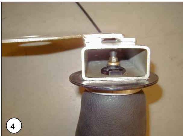
**NL** Monteer de moer op de luchtbalg. Draai deze zover aan dat de luchtbalg nog net kan draaien.
