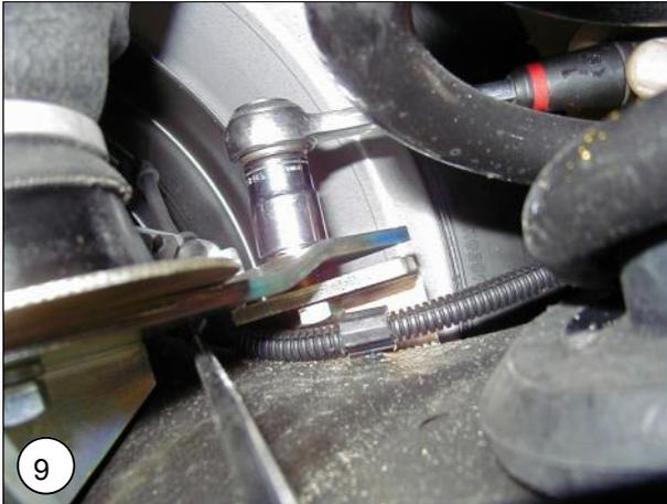
**NL** Draai de moer van de onderbeugel vast met **40 Nm**.
