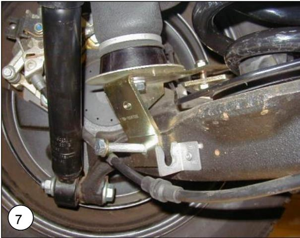
**NL** Verwijder de rubber stop uit de voorzijde van de draagarm en monteer de onderbeugel in de ovale gaten van de draagarm. Plaats de lange bout door de onderbeugel.
