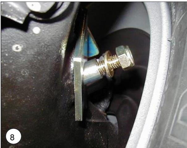
**NL** Monteer de vulbus, sluitring en borgmoer aan de voorzijde. Zet deze bout vast met **40 Nm**.
